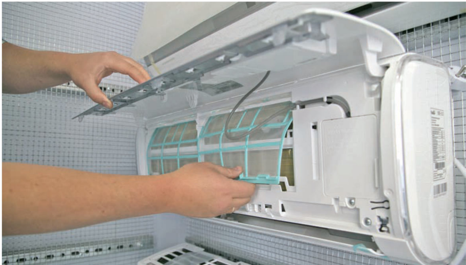
Извлечь воздушный фильтр бытового кондиционера проще, чем кажется. Фото: Лидия ВЕТХОВА
