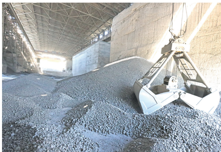
Из бункера хранения клинкера поступает на мельницу.
