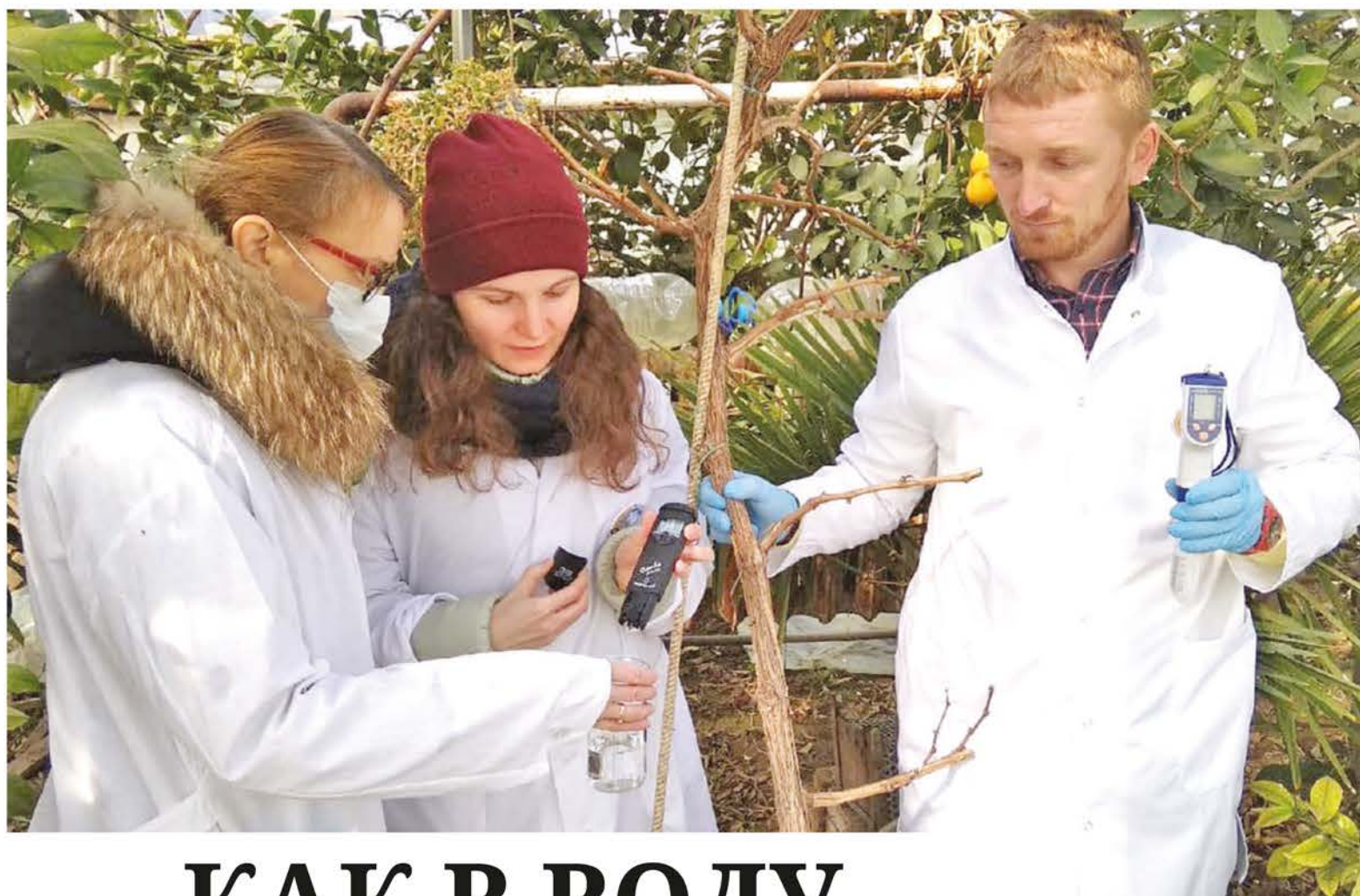
В полевых условиях воду сразу же можно проверить на электропроводность.
