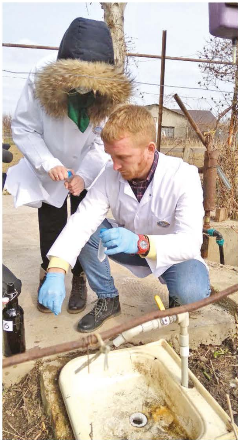
Забор проб из скважины для лаборатории и проведение анализов прямо на месте.
